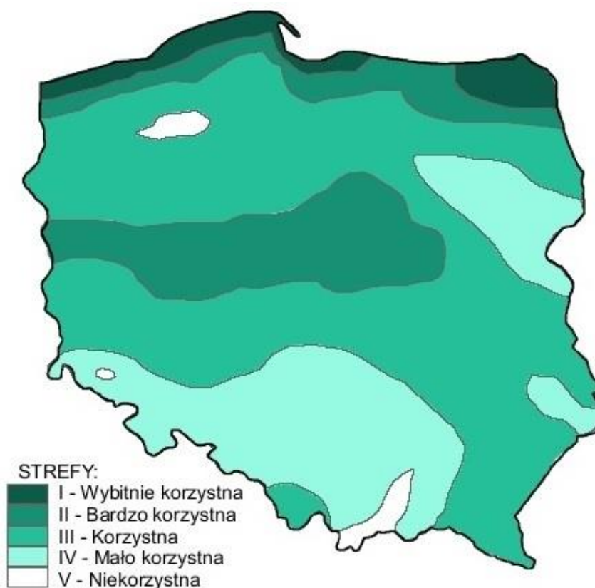
Rysunek 12. Strefy energetyczne warunków wiatrowych. źródło: imgw.pl
